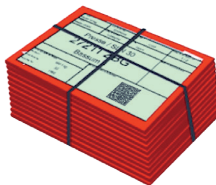
Beispiel Bundfertigung mit Bundverschnürung
